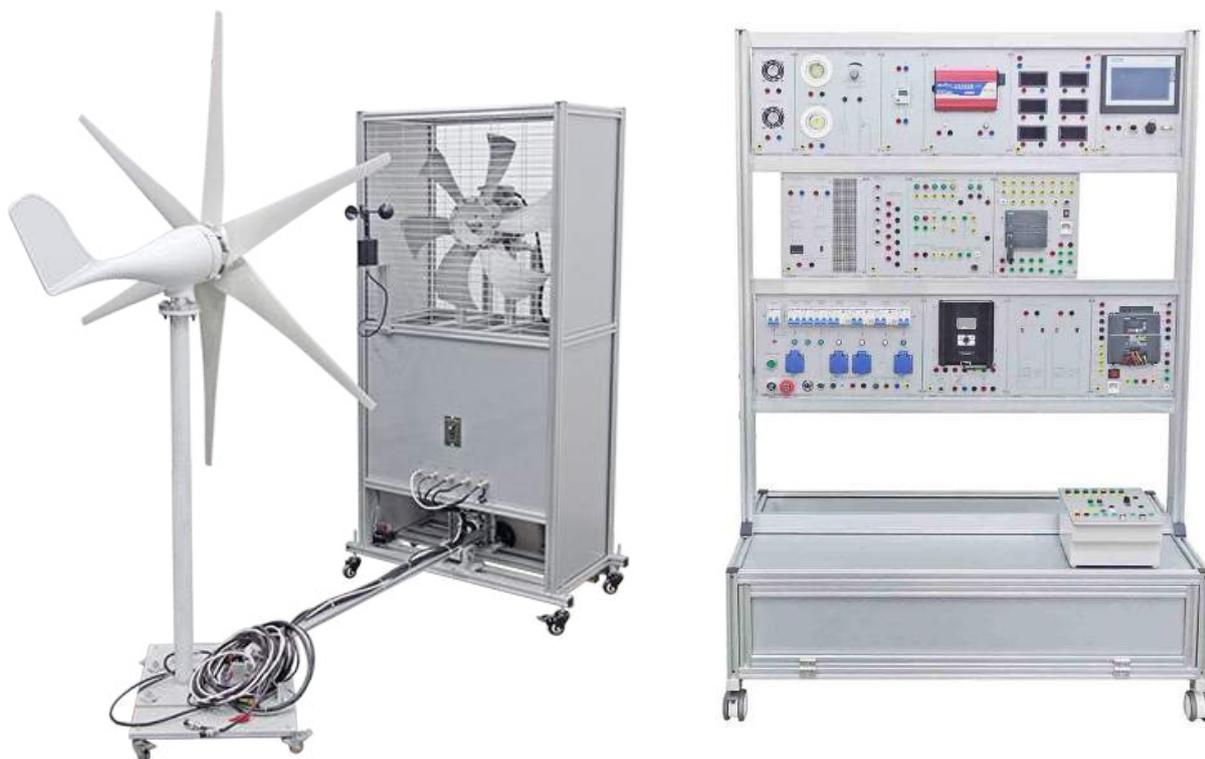
Il Laboratorio didattico per la generazione di energia eolica consente agli studenti di condurre indagini sulla generazione di energia eolica. È dotato di una ventola assiale ad alta potenza per simulare la velocità del vento in modo realistico e consente di studiare le prestazioni del sistema all'interno del laboratorio indipendentemente dalle condizioni esterne.
